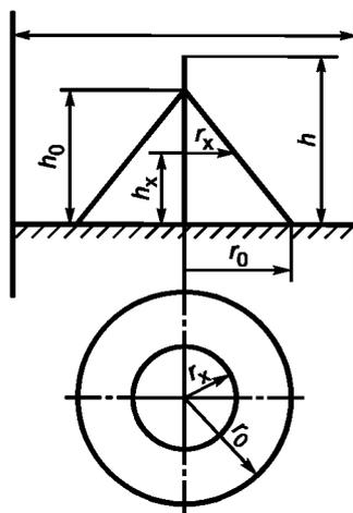
Рисунок А.1 — Зона защиты одиночного стержневого молниеотвода
