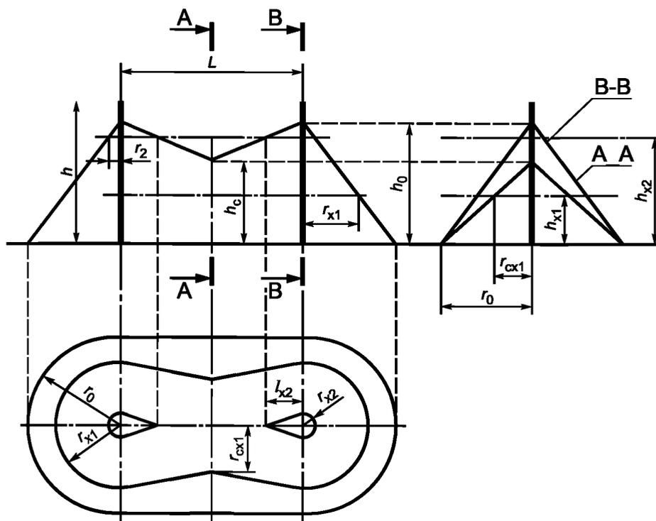
Рисунок А.3 — Зона защиты двойного стержневого молниеотвода
