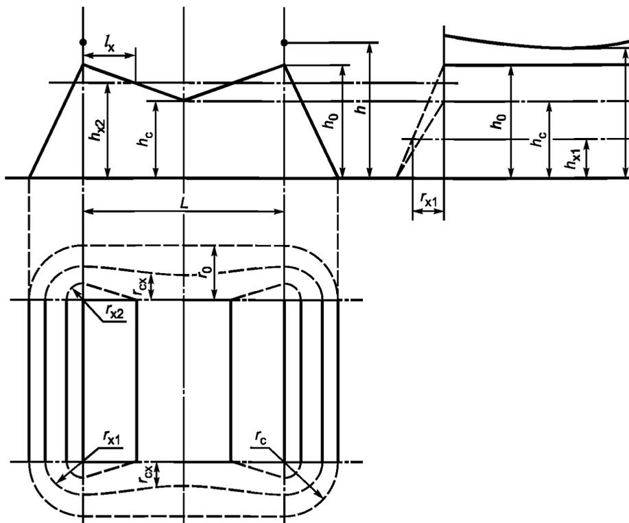
Рисунок А.5 — Зона защиты двойного тросового молниеотвода
