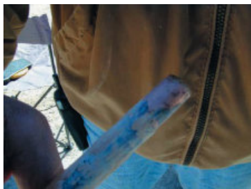
Штырь заземления с медным покрытием толщиной 254 мкм, извлеченный из грунта (суглинок) после 10 лет
