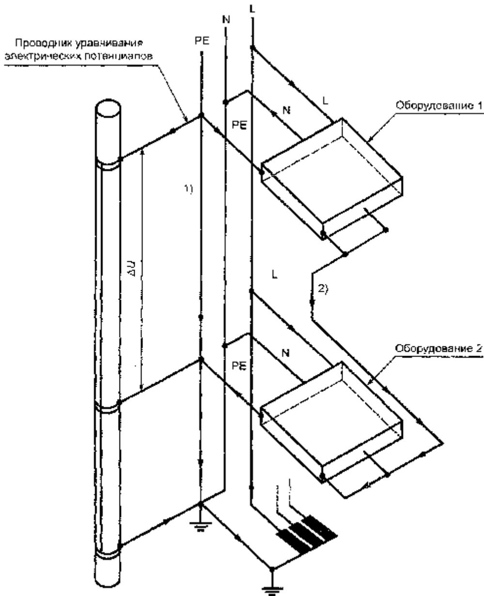
1) — пути токов при устранении падения напряжения  $\Delta U$  вдоль PE;
